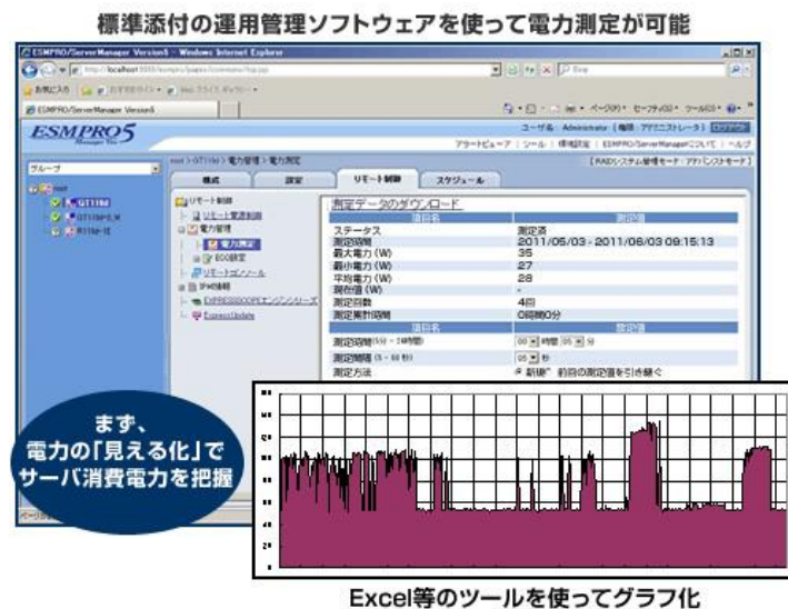
図 2-23 ICT 機器添付の運用管理ソフトウェアと本体装置搭載の BMC の連携事例
