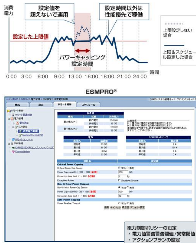
図 2-25 ICT 機器添付の運用管理ソフトウェアの電力ピーク制御運用設定事例
