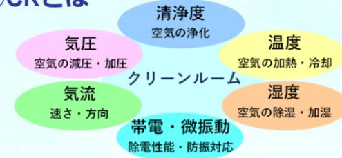
CRとは、「空気中に浮遊する微粒子や微生物が限定されたレベル以下の清浄度に管理（コンタミネーションコントロール）され、不純物やゴミ（＝塵埃）を持ち込まないようにするための部屋」であり、さらに「温度、湿度等を要求される環境とし、外からの塵埃が進入しないように室圧を制御した部屋」と定義されている。
