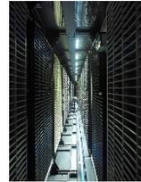
過去の実績からアクセス頻度の低いデータ多いことがわかっています。12PBのLustre、1PBのGPFS、20PBのテープの3段のストレージを使い分けます。
