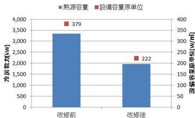
図1 改修前後の熱源設備容量
