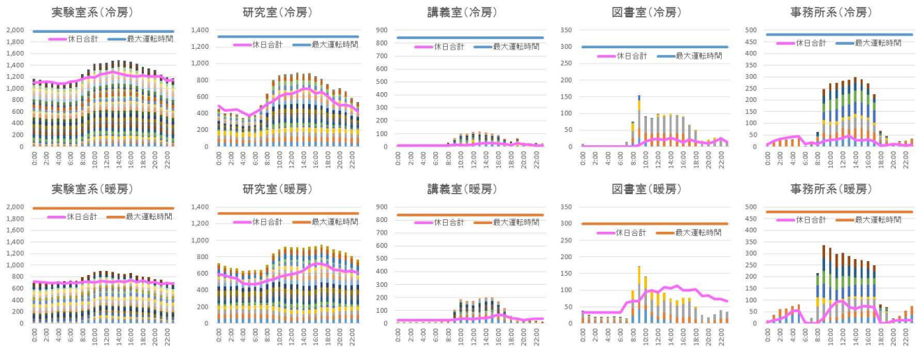
図7 冷房時(8月)と暖房時(2月)における用途別室外機平均稼働時間
